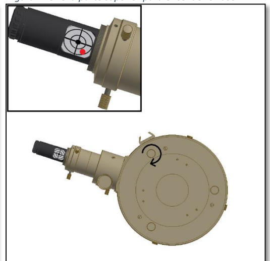
Figura 4. Gire la ventana del visor láser para que el punto del láser sea visible al ajustar el espejo primario.
