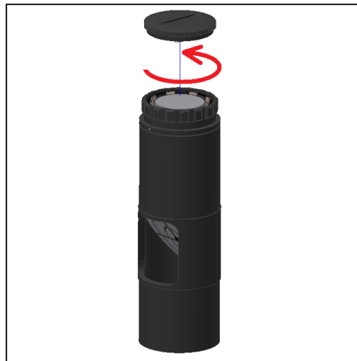
Figura 1. Saque la tapa para ver la pila.
