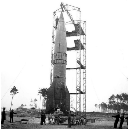
Dieses Bild zeigt vermutlich das erste Versuchsmodell der A4 im März 1942. Bei einem Startversuch am 14. März explodierte die Rakete bei der Zündung.
